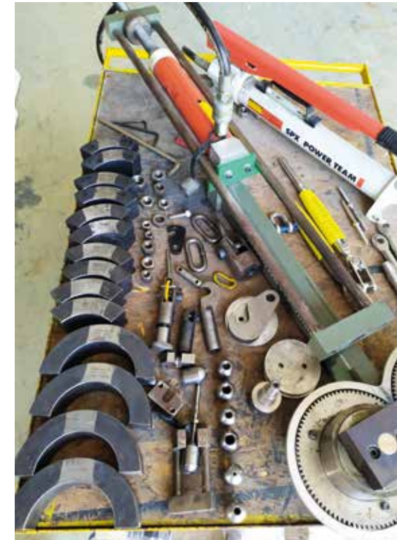
Terminal sıvama makinesi ve değişik çapta tel ve terminas için aparatlar
