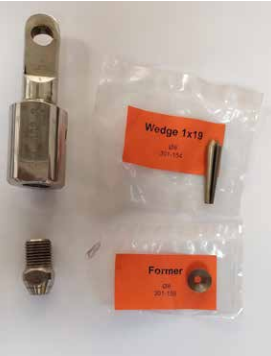
Norsmen terminal ve her tel değişiminde yenilenmesi gereken iç çekirdekleri
