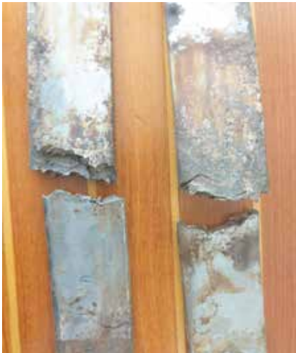
Durağan su ile kimyasal reaksiyona uğrayıp kopmuş çarmıh ayakları
