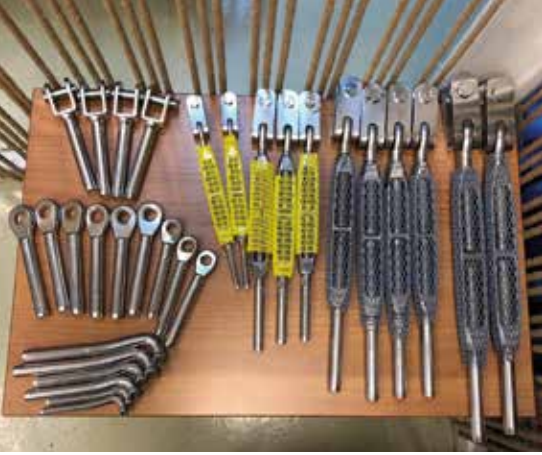
37 feet modern bir teknenin tüm arma terminalleri ve kopan bir mapa
