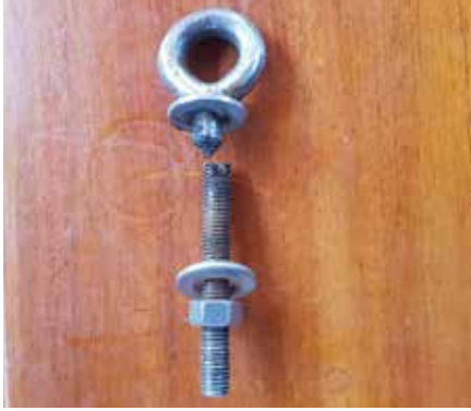
37 feet modern bir teknenin tüm arma terminalleri ve kopan bir mapa
