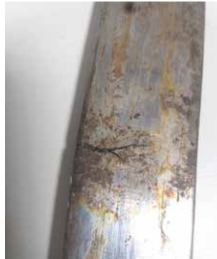
Durağan su ile kimyasal reaksiyona uğrayıp kopmuş çarmıh ayakları
