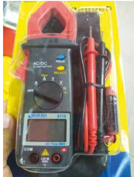
Arıza tespiti için bir doktorun stateskopu yerine geçecek basit ama yeterli bir multimetre
